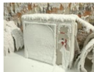
Badanie symulowanym opadem śniegu
