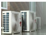
Badanie symulowanym opadem deszczu
